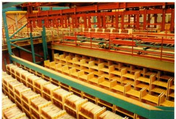
Automatic device for loading dry material on U-setters Automatismo di carico materiale secco su cassette ad "U"
