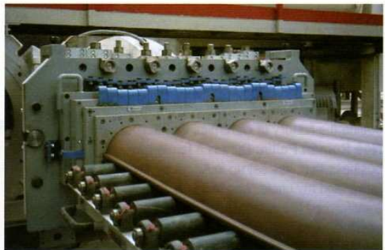
Detail of 4-exit extrusion of "árabe" tile Dettaglio estrusione tegola árabe a 4 uscite
