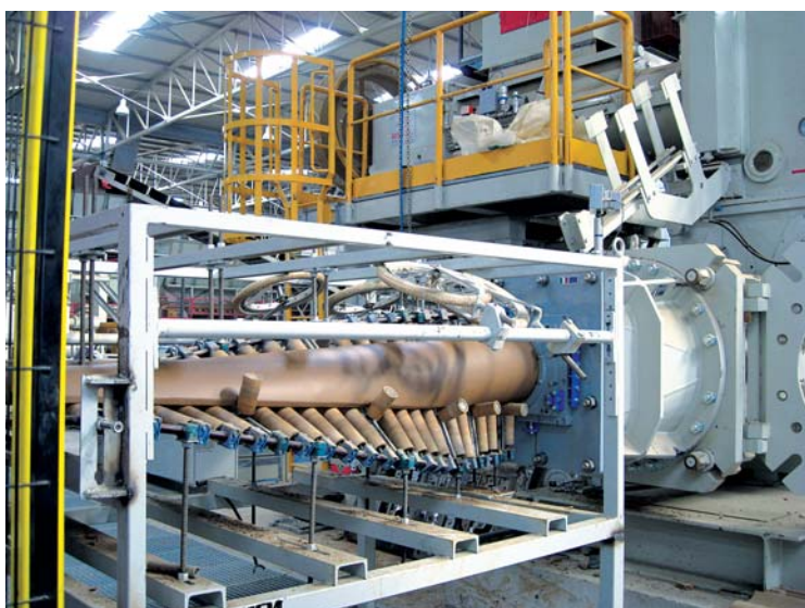
Robot per il carico del verde. A robot used to load green products.
