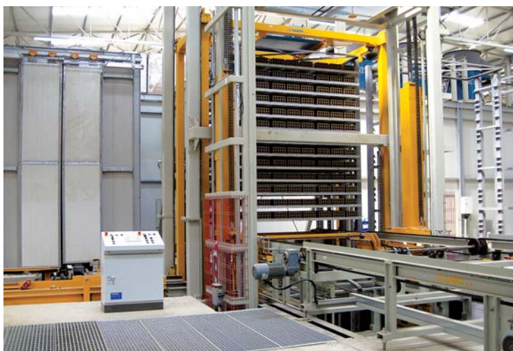
Automatismo di carico del materiale verde ed ingresso nell'essiccatoio. Automatic green ware loading/dryer feeding system.
