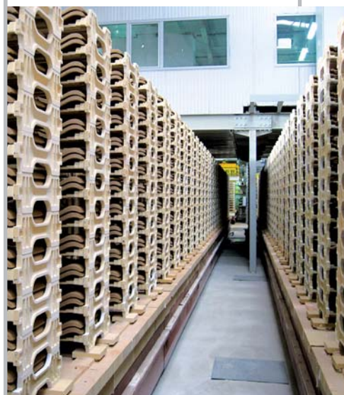
Caselle ad "H" su carro forno con materiale secco. "H"-shaped boxes with dry ware on the kiln car.
