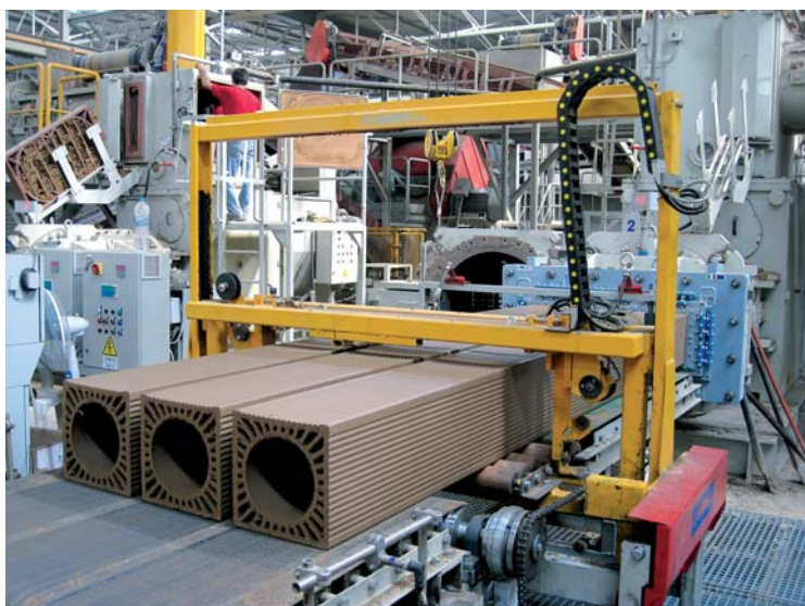
Fase di formatura di elementi per canne fumarie. Extrusion of chimneys.
