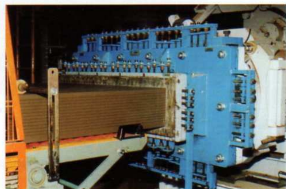
Wide exit extrusion stage Fase di trafilazione a larghe uscite
