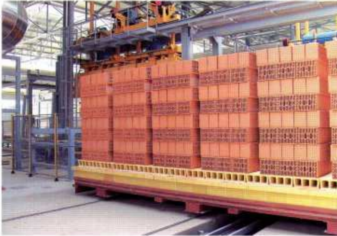
Carro forno in corrispondenza dello scarico. Oven trolley at the unloading point.
