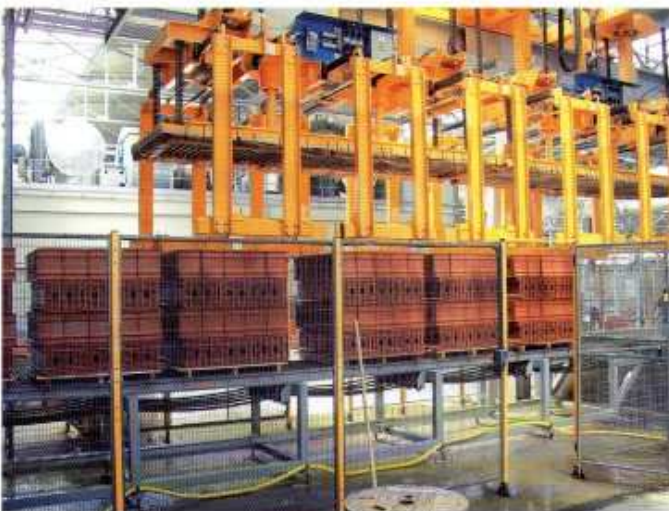
Pacchi confezionati sulla linea di bagnatura. Wrapped packs on the wetting line.
