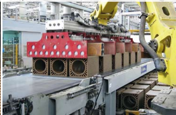
Robot for greenware loading Robot per il carico del verde
