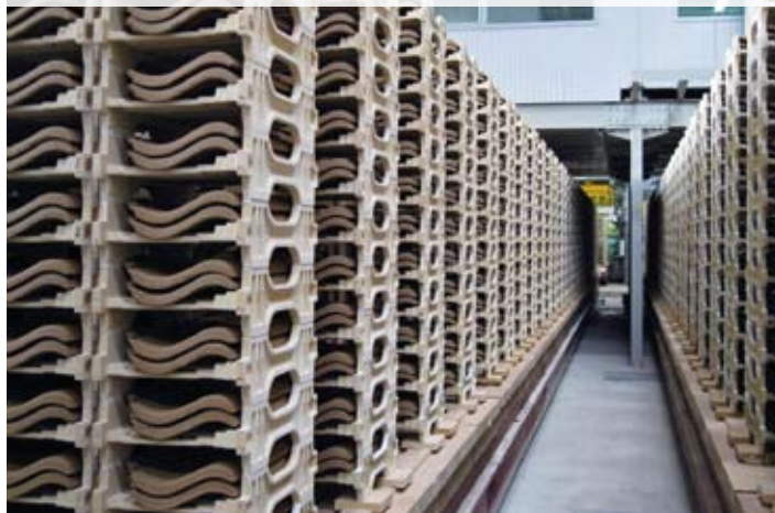
H-cassettes on kiln car with dried material Caselle ad "H" su carro forno con materiale secco
