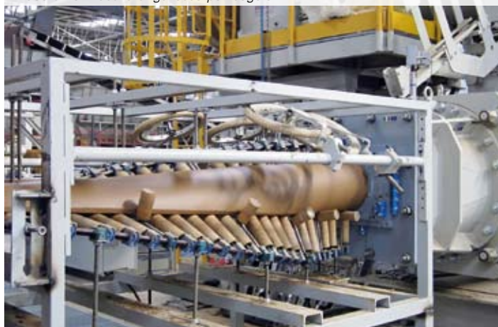
Shaping of bats for roof tiles Fase di formatura di gallette per tegole
