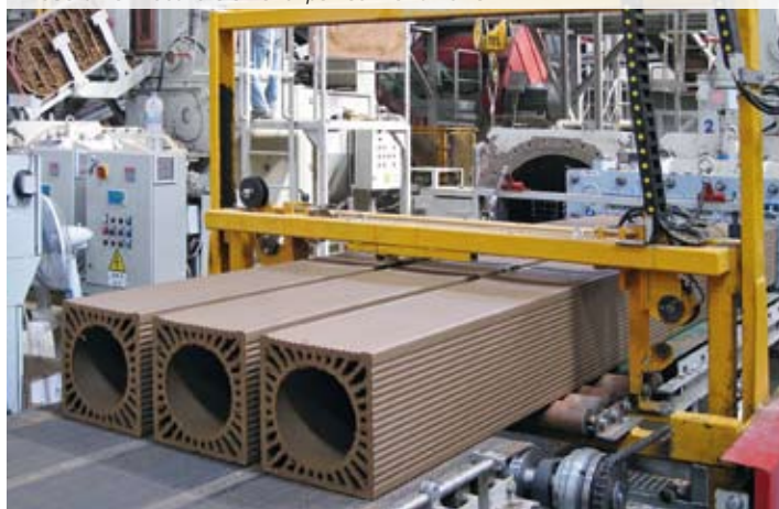
Shaping stage for chimney elements Fase di formatura elementi per canne fumarie
